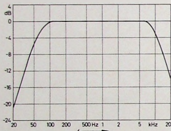
Bild 9. Frequenzgang bei eingeschalteten Höhen- und Tiefenfiltern
